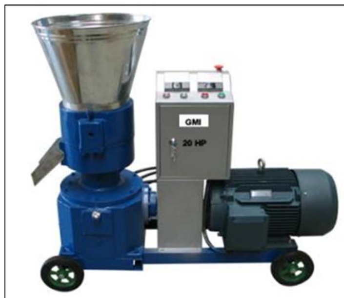
Εικόνα 23: Πρέσα παραγωγής πέλλετ
