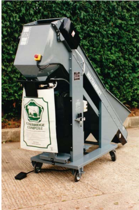
Εικόνα 24: Μηχανή ενσάκισης πέλλετ
